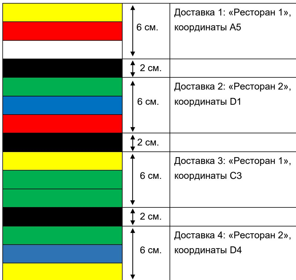
4. «Город» - поле, разбитое на клетки линиями (координатная плоскость, где абсциссы обозначаются буквами A, B, C, D, E, а ординаты цифрами 1, 2, 3, 4, 5. Размеры клетки **300x300 мм**. Ширина линий **18-20 мм**. Квадратные зоны доставки товара, размером **60x60 мм**. Метки на поле выделены линиями темного цвета (**ширина линии 1-2 мм**).
